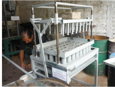
Ilustración 12. Equipo necesario para la Producción de Briquetas Generadoras de Calor.
