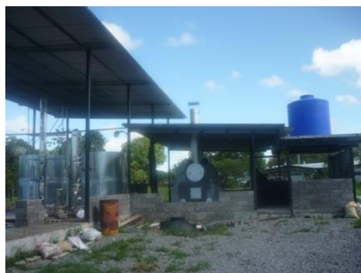
Ilustración 18. Construcción de Bio-reactor para producir etanol utilizando los desechos de la producción de productos lácteos.
