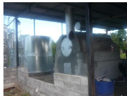
Ilustración 18. Construcción de Bio-reactor para producir etanol utilizando los desechos de la producción de productos lácteos.
